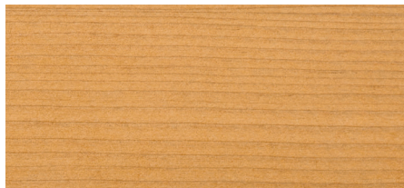
nach Kartenton ASP 432-5 (Art.: JC6330-8121) 95,5 T farblos, 2 T gelb, 1,2 T rot, 1,3 T schwarz
