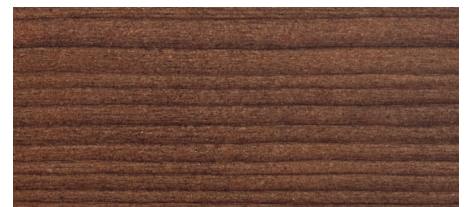
nach Kartenton ASP 432-12 (Art.: JC6330-8126) 81 T farblos, 3 T gelb, 5 T rot, 11 T schwarz
