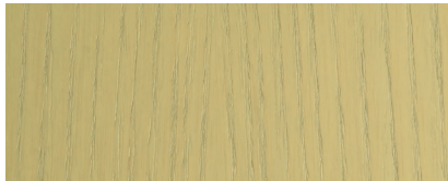
nach Kartenton ASC 532-4 (Art.: JC6340-6101) 66,5 T farblos, 30 T weiß (P), 3 T gelb (P), 0,5 T schwarz (P)
