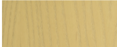
nach Kartenton ASC 532-2 (Art.: JC6340-1103) 66 T farblos, 30 T weiß (P), 3,7 T orange (P), 0,3 T schwarz (P)
