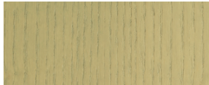
nach Kartenton ASC 532-5 (Art.: JC6340-6102) 65 T farblos, 30 T weiß (P), 4 T gelb (P), 1 T schwarz (P)
